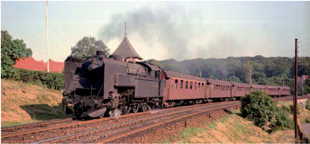
Hillerødtoget er i 1964 på vej op ad stigningen nord for Holte Station. Et typisk Nordbanetog med S-maskine og en stribe CL-vogne med 2. klasse og til sidst en tilsvarende CLE med rejsegodsrum. Men første vogn er en 1. klasse sidegangsvogn litra AC, som var mere populære blandt de „fine“ kunder end „akvarierne“. (HGC)
