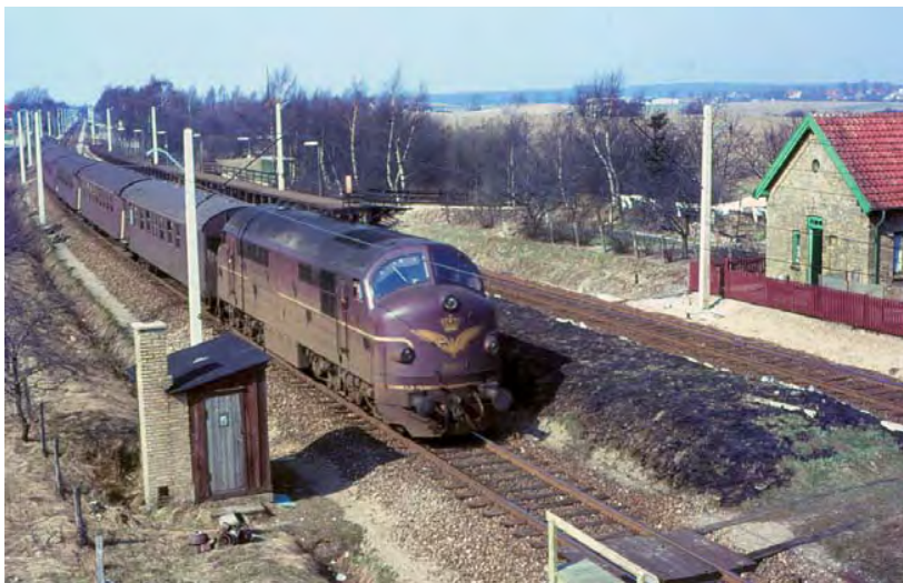
Fra 1961 anskaffede DSB nye MX-diesellokomotiver, som på Nordbanen overtog det meste af kørslen, så damplokomotiverne kun var i brug under spidsbelastninger som myldretid og sommerweekender. MX-lokomotiv med tog mod København ved Høvelte 1967. Masterne til elektrificeringen er allerede sat op. (KJ)
